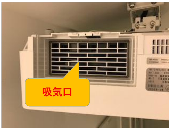
④エアダスターなどを使用して吸気口の本ホリの除去を行ってください
