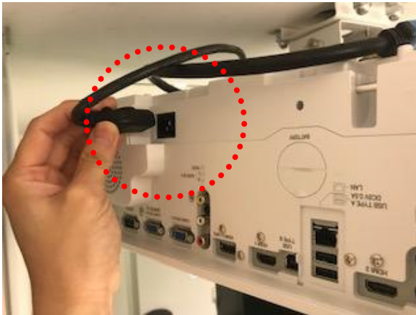
①プロジェクター本体の電源切り、電源プラグを抜いた状態で作業を行います。
