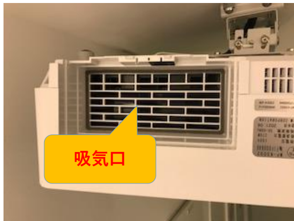
④エアダスターなどを使用して吸気口のホコリの除去を行ってください
