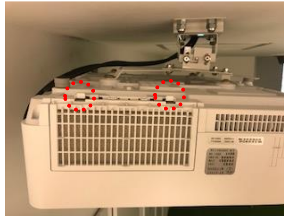
②フィルターカバーを外します。 ※2点爪を外すとカバーが外れます。
