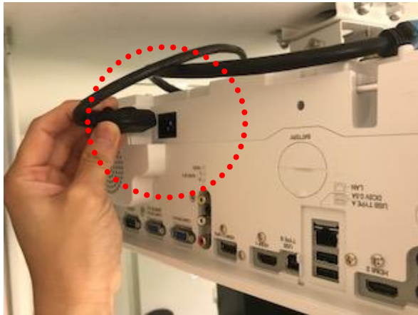
①プロジェクター本体の電源切り、電源プラグを抜いた状態で作業を行います。
