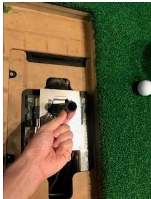
ドライバーで3ヶ所のネジを外し、新しいゴムティーと交換します。
