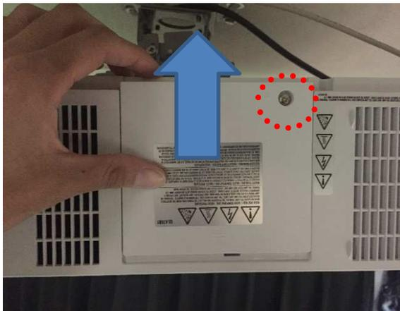
ランプカバーのネジを外し、カバーをスライドさせて取り外します。
