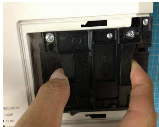
ランプBOXのネジ3点を緩め、つまみを持ってランプBOXを取り外し、新しいランプを取り付けて下さい。
