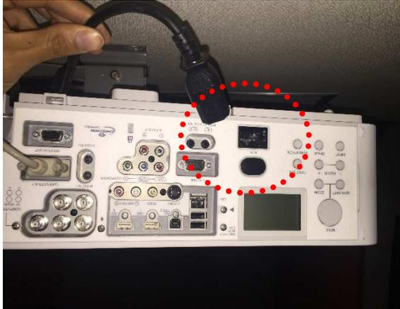
PJ本体の電源切って電源プラグを抜いた状態でランプ交換作業を行って下さい。
