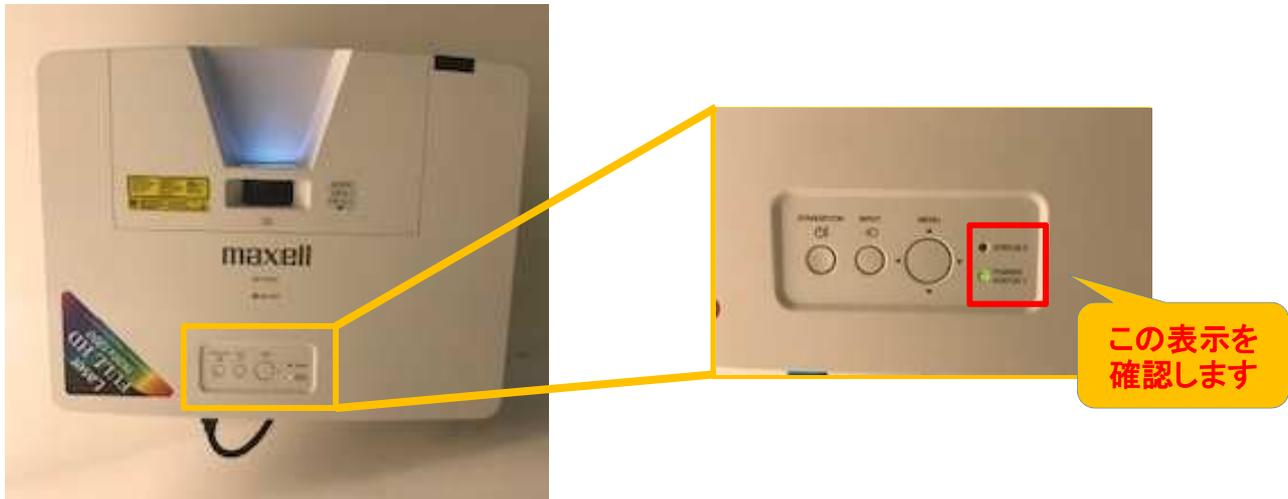
※内部温度が上がりすぎると、安全のため、自動的に電源が切れることがございます。このときにインジケータが全て点灯することがあります。この場合はすぐに電源コードを抜いて、20分以上待って冷ましてください。本機が十分に冷えてからもう一度電源を入れてください。
