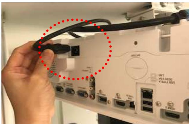
① プロジェクター本体の電源切り、電源プラグを抜いた状態で作業を行います。
