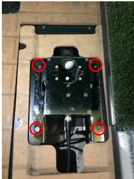
前方の配球口を固定しているネジ2点も同様に外し金物を上に向かって引き上げると金物が外れてオートティーアップが取り出せます。
